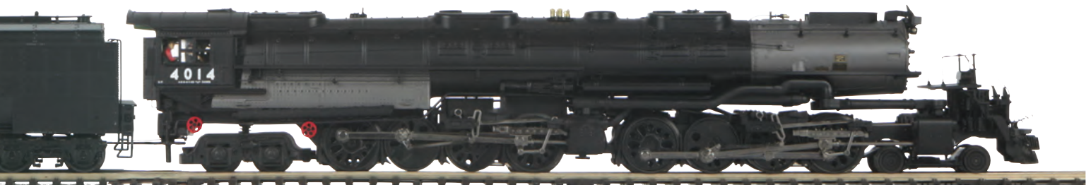
Union Pacific - Dampflokomotive 4-8-8-4 Big Boy (Ölfeuerung) 20-3575-1 Räder mit hohem Spurkranz 22-3575-2 Maßstäbliche Räder
