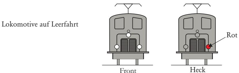
Um die Beleuchtung der Lokomotive auf Anzeige Zug umzuschalten, betätigen Sie die Softkey-Taste LMK, so dass im Display der DCS-Fernbedienung wird "Marker Light OFF" (Markierlichter aus) angezeigt wird. Die Beleuchtung der Lokomotive entspricht nun folgendem Muster (Lokomotive mit Zugverband):
