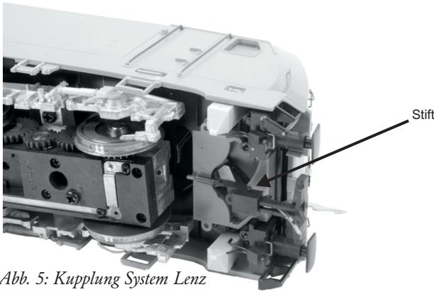
Abb. 5: Kupplung System Lenz
