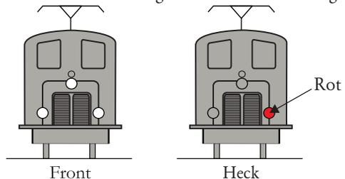
Beleuchtung der Lokomotive umstellen auf Zugverband: Glocken-Drucktaste ein Mal kurz antippen, anschließend Signalhorn/Pfeife-Drucktaste ein Mal kurz antippen.
