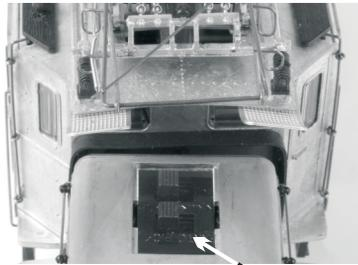
Abb 4: Wahlschalter, Oberleitung/Schiene
