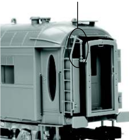
Die Faltenbalgstützen am Faltenbalg befestigen.
