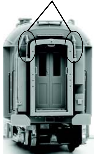
Die Faltenbalgstützen an den Stirnwänden des Wagenkastens anbringen
