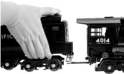
Abb. Lokomotive und Tender verbinden
